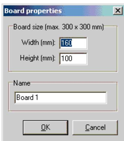
В открывшемся окне можно задать **Ширину** - [Width](#) и **Высоту** - [Height](#) платы, а также ее **Название** - [Name](#), которое будет отображаться на закладке. Размеры платы не могут быть больше, чем 300x300 мм.
