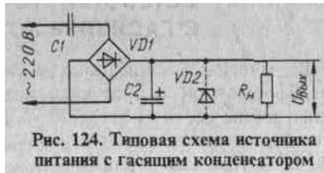
диодным мостом, а нагрузка, зашунтированная другим конденсатором, питается от выходной диагонали моста (рис. 124). В этом случае цепь становится резко нелинейной и форма тока, протекающего через мост и гасящий конденсатор, будет отличаться от
