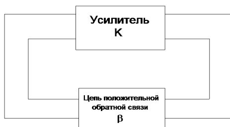
Рис. 4. Структурная схема автогенератора
