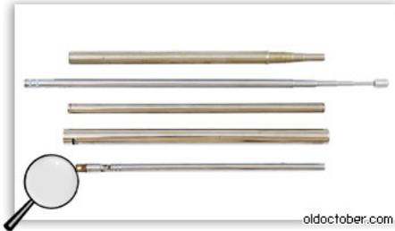
Тонкостенные трубки различного диаметра можно получить при разборке сломанной телескопической антенны от радиоприёмника или магнитолы. Как разрезать секцию антенны и развальцевать край трубки, показано в видеоролике.
