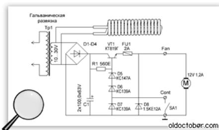
Основой схемы служит параметрический стабилизатор напряжения, собранный на элементах: VT1, D5, D6, D7 и R1. Он обеспечивает стабилизацию напряжения питания вентилятора фена, в то время как напряжение основного источника питания может меняться для регулировки температуры воздушного потока.
