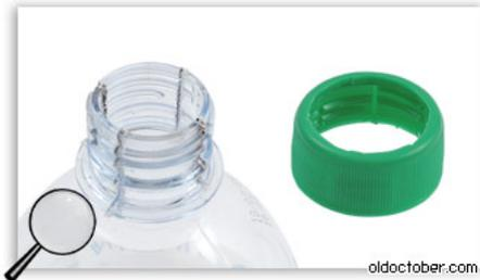
Крепление корпуса нагревательного элемента к корпусу фена осуществлено с помощью четырёхлепесткового цангового зажима. Для этого винтовая часть горлышка бутылки была разрезана на четыре части с помощью ножовки по металлу, а в крышке проделано отверстие скальпелем.
