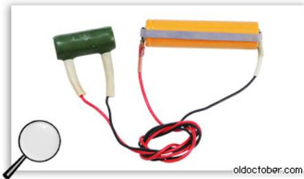
Внимание! Перед разборкой аккумуляторной банки, её нужно обязательно разрядить. Сделать это можно с помощью мощной, низкоомной резистора. Я использовал 10-Омный резистор ПЭВ, мощностью 10 Ватт, которым обычно разряжаю электролитические конденсаторы.
