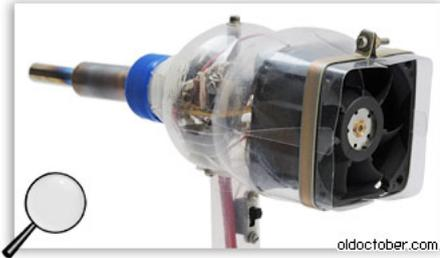
Для крепления вентилятора к ПЭТ бутылке, были изготовлен хомут из жести толщиной 0,5мм.
