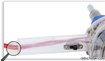
Ручка фена была изготовлена из цилиндра 40-граммового одноразового шприца. В ней острым ножом было вырезано прямоугольное окошко для установки переключателя мощности вентилятора.
