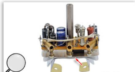
Так как транзистор стабилизатора может рассеивать мощность до 24 Ватт, он установлен на радиатор. Радиатор может быть изготовлен из листового алюминиевого сплава, например, из алюминиевой консервной банки. Общая толщина набора пластин радиатора должна быть не меньше 1,5мм. Между транзистором и отдельными пластинами нужно нанести слой теплопроводной пасты.
