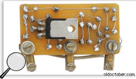
Замечу, что ПП была разработана под давно забытую технологию изготовления плат на основе пустотелых заклёпок – пистонов. Поэтому, все дорожки имеют вид прямых линий.
