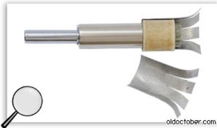
Для того чтобы защитить горлышко ПЭТ бутылки от перегрева, корпус нагревателя был изолирован несколькими десятками слоёв стеклоткани. Для дополнительной защиты корпуса фена от перегрева использован алюминиевый тепловой экран толщиной 0,5мм. Отогнутые внутрь корпуса лепестки экрана обдуваются воздушным потоком. Такая конструкция снижает передачу тепла от корпуса нагревателя к корпусу фена.
