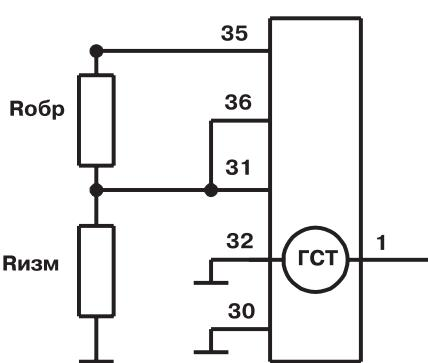
**Рис.4. Схема измерения сопротивления**
