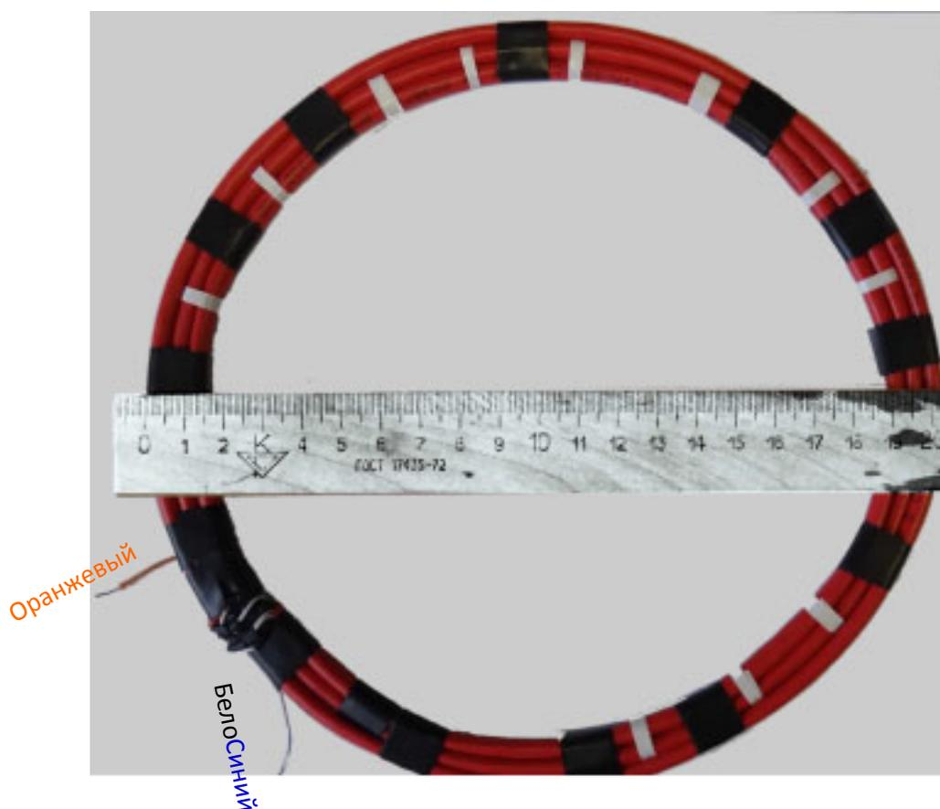
Зачищаем провода соединяем и распайваем согласно таблицы
