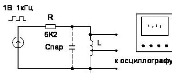
Резистор **R** пришлось выбрать достаточно высокоомным, 6,2 кОм, так как в противном случае сложно наблюдать свободные колебания контура, образованного индуктивностью **L** обмотки и ее паразитной емкостью **Спар**. При резисторе малого сопротивления
