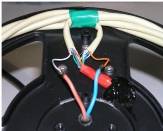
Остается только залить термоклеем места пайки, а также места выхода проводов из кабеля «витая пара», для предотвращения возможного проникновения туда воды. Герметизируется также и место выхода кабеля из кронштейна датчика. Для укладки проводов кабеля нужно не забыть вырезать кусачками два прохода во внутреннем кольцевом ребре жесткости. Итоговый внутренний вид датчика показан на фото.
