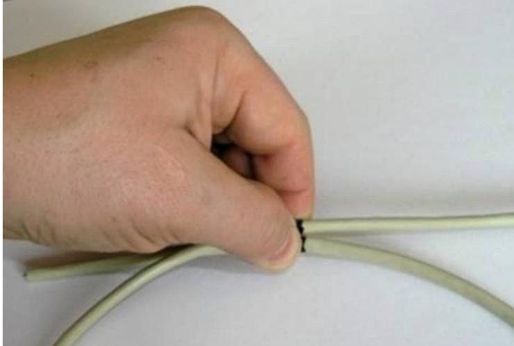
Затем начинаем продевать свободный длинный конец кабеля в образовавшуюся петлю, обивая вторым витком кабеля первый. За один оборот витка будущей катушки датчика нужно сделать 4-5 обвивок, то есть 4-5 раз продевать свободный конец кабеля через кольцо создаваемой обмотки. Ниже изображена первая обвивка вторым витком первого витка.
