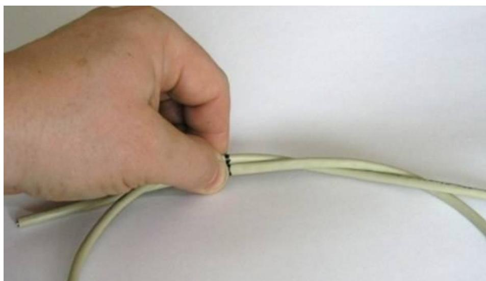
При намотке всех 4-х витков необходимо следить, чтобы кабель укладывался, строго повторяя период обвивки предыдущих витков. В этом случае итоговая «барабанка» полученной обмотки будет компактной, плотной и аккуратной, как это показано на фото.
