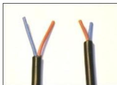
Конец с длинными выводами распайивается в корпусе датчика, конец с короткими – в разъеме. В настоящий момент мы в своих изделиях используем микрофонные разъемы типа XLRmini на 5 контактов. Такие разъемы применяются и в большинстве металлодетекторов других производителей. В кабельной части разъема устанавливается также и идентифицирующий резистор номиналом 30 кОм. Схема распайки разъема поясняется ниже.
