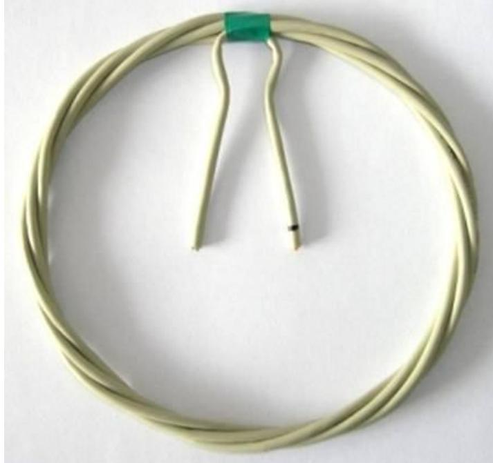
Концы кабеля фиксируются изолентой и отгибаются внутрь обмотки. Концы кабеля укорачиваются до свободной длины 6 см. На длине 3,5 см от концов кабеля удаляется внешняя оболочка. Делать это можно, например, маникюрными ножницами. При любом способе главное – не повредить внутренние проводники и их изоляцию!
