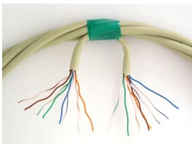
Концы всех проводов зачищаются на длину около 5 мм и облуживаются. Затем производится распайка концов проводов. Семь проводов из одного конца кабеля соединяются с семью проводами другого конца кабеля. Оставшиеся свободными два провода будут выводами обмотки. Изоляция проводов имеет четыре цвета обозначения –
