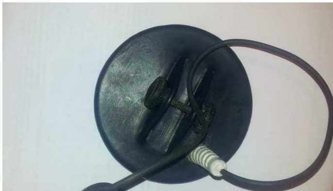
Внешний диаметр по меди 110мм Размах TX по ослу 17.5В, КУ предваря 60
