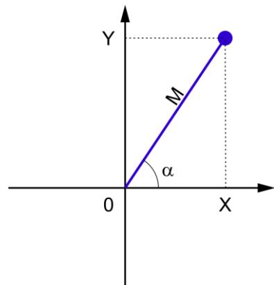
На экране в графическом виде отображаются проекции вектора разбаланса X (верхняя строка) и Y (нижняя строка), а так же в числовом виде размах разбаланса в милливольтах (верхняя строка) и угол вектора разбаланса в градусах (нижняя строка).
