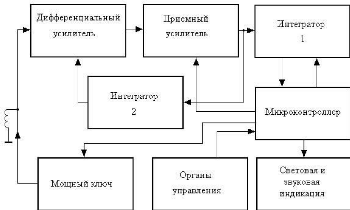
Рис.2. Структурная схема импульсного металлоискателя.
