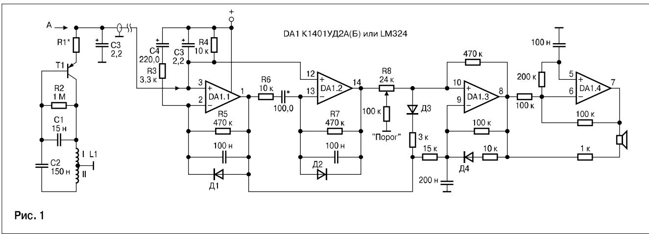
ски любым структуры р-п-р, даже германиевым с малым усилием. Конденсатор С1 желательно будет подобрать с емкостью в пределах 5–20 нФ по максимальной чувствительности контура. Иногда хороший результат бывает при подключении С1 не к обмотке II, которая является базовой, а к общему проводу. Катушка контура имеет диаметр 14–16 мм, на ней намотано 260 витков провода диаметром 0,2–0,5 мм с отводом от сто шестидесятого витка.
