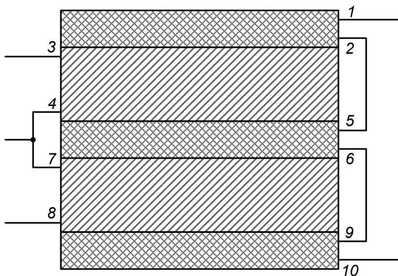
Рисунок 2 – Расположение обмоток выходного трансформатора
