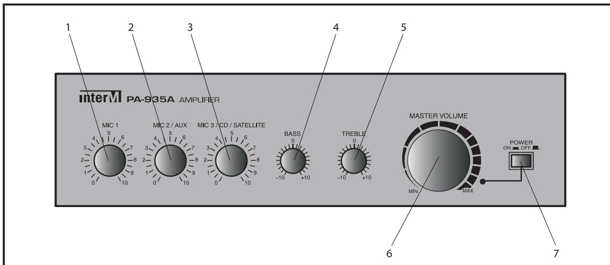
**1. Регулятор уровня сигнала микрофонного входа MIC 1.**
