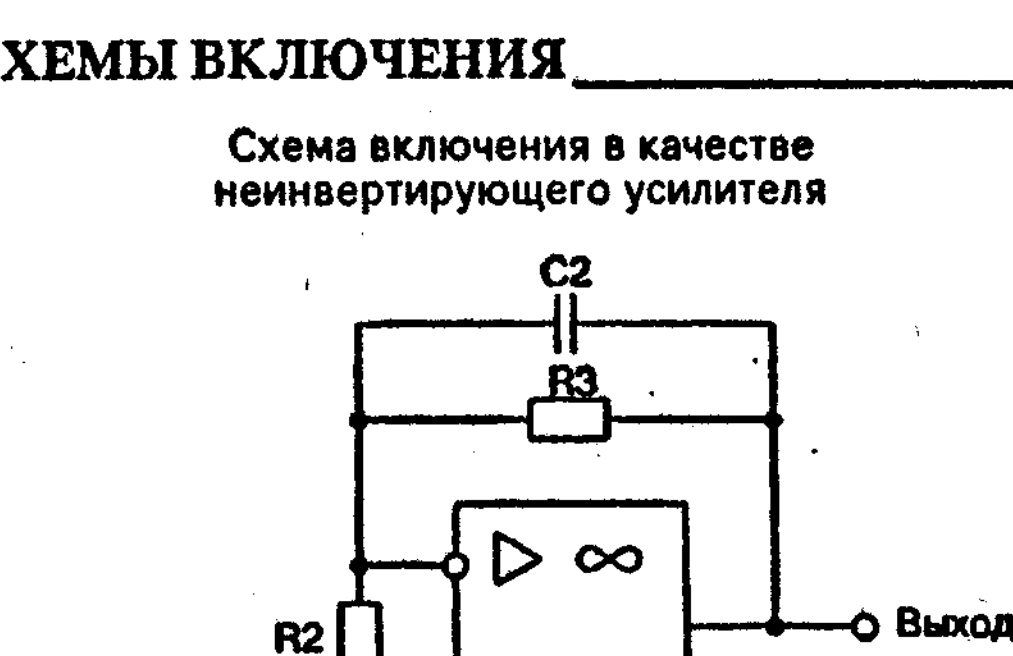
Схема включения в качестве неинвертирующего усилителя
