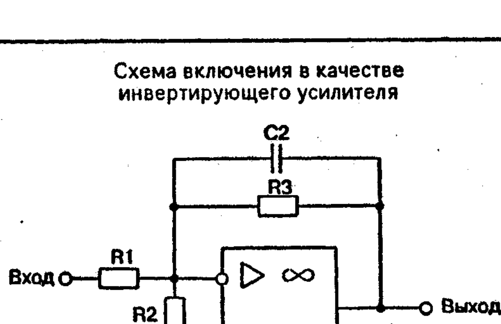
Схема включения в качестве инвертирующего усилителя
