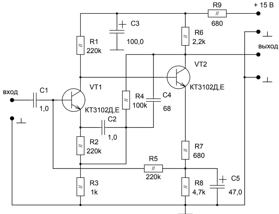
$R_{вх.} = 200 \text{ кОм}$        $с/ш = 78 \text{ дБ при } U_{вых.} = 1 \text{ В}$
